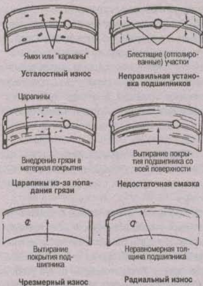
20.1 Виды и причины износа коренных и шатунных подшипников.
