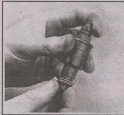
26.4в Оденьте новое кольцо через головку форсунки так, чтобы кольцо зашло в выемку
