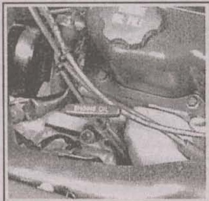
4.4а Щуп указателя уровня масла в двигателе находится в передней части блока цилиндров (со стороны радиатора)
