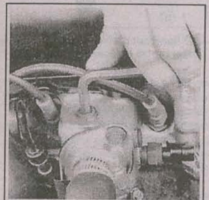
32.4б Чтобы слить жидкость на двигателях 2,2 и 2,5 л необходимо вывернуть вентиляционную заглушку в верхней части термостата
