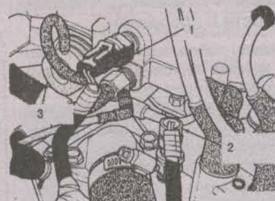
34.8b Разъем датчика температуры жидкости на двигателе 3,0 л
