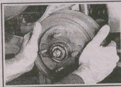
30.8 Подайте на себя барабан тормоза, чтобы вышел наружный подшипник
