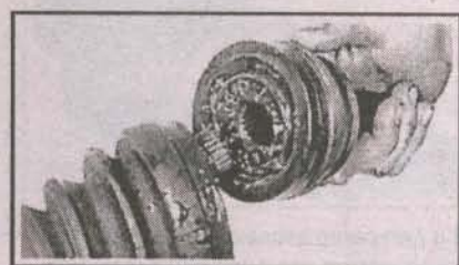
9.21б Отсоедините кожух шарнира от соединительного вала
