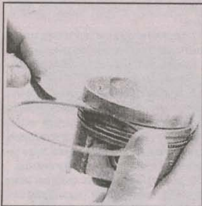
19.9 Измерение зазора между канавкой и кольцом
