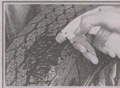
5.4б Если воздух сквозь вентиль не проходит, то установите место течи, опрыскав шину мыльным раствором
