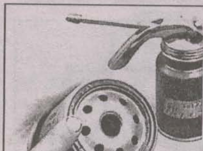
9.14 Смажьте маслом для двигателя уплотнительное кольцо нового фильтра
