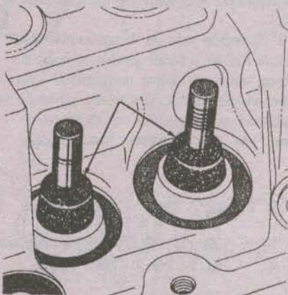
11.9а Маслоъемные колпачки для впускных и выпускных клапанов отличаются 1. Колпачки
